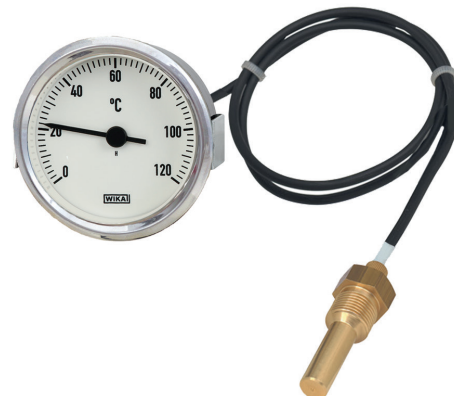
Utförande med kromat stålplåtshus med kromad frontring och bygel. Plastad distansledning. Anslutning med skyddsficka av mässing L-45 mm G1/2"
